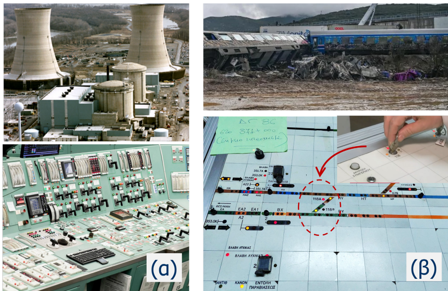
Εικόνα 1.6 Η διεπαφή χρήστη σε περιβάλλοντα κρίσιμων λειτουργιών: Three Miles Island (1979) (αριστερά), Σιδηροδρομικός Σταθμός Τεμπών (2023) (δεξιά). Σε κρίσιμα συστήματα όπως πυρηνικοί σταθμοί ή σιδηροδρομικά δίκτυα, η σαφήνεια της πληροφορίας, η ιεράρχηση συναγερμών και η αναπαράσταση της συνδεσιμότητας του συστήματος αποτελούν κρίσιμους παράγοντες για την έγκαιρη και ορθή λήψη αποφάσεων.
